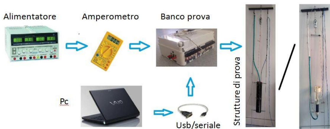
Figura 49 Postazione di test
